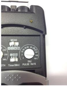
Auf dieser Einstellung kann die **Impulsstärke eingestellt** werden, welche durch die Haut geleitet wird. Beim Drehen kann die Impulsstärke pro Sekunde zwischen 2-150 Hz eingestellt werden. **Empfohlen wird die Einstellung zwischen 70 – 120 Hz.**
