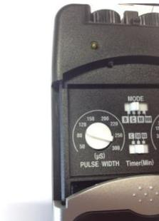
Auf dieser Einstellung kann die **Impulsdauer des elektrischen Signals** eingestellt werden, welche durch die Haut geleitet wird. Beim Drehen kann die Impulsdauer pro Sekunde zwischen 50 – 300  $\mu$ S. **Empfohlen wird die Einstellung zwischen 70 – 120  $\mu$ S.**
