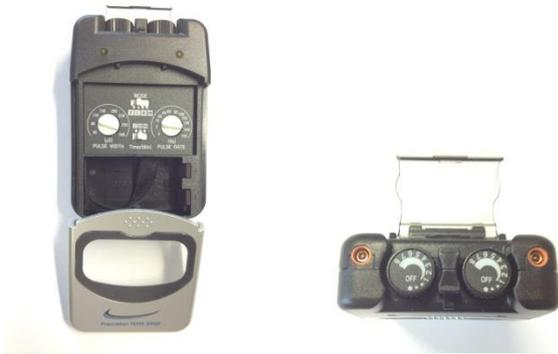
Achten Sie darauf, die Verpackung von der 9V-Batterie zu entfernen. Kontrollieren Sie die Plus- und die Minuspol des Batterie-Anschluss. Stellen Sie sicher, dass beide „IntensityControl“ (ON / OFF-Schalter) Knöpfe in der Aus-Stellung geschaltet sind.
