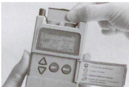
Einzelne Protokolle prüfen und löschen. Halten Sie «MODE» gedrückt und schalten Sie gleichzeitig das Gerät ein. Die LCD-Anzeige zeigt die Anzahl der Protokolle (Individual Records) und die Behandlungsdauer an. Drücken Sie den «Increment»-/«Decrement»-Knopf, um die einzelnen Protokolle zu prüfen. Um ein Protokoll zu löschen, halten Sie «SET» 3 Sekunden lang gedrückt.
