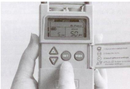
d. Impulsfrequenz einstellen. Die Impulsfrequenz kann auf Werte zwischen 2 Hz und 150 Hz eingestellt werden. Drücken Sie «SET», um in das Menü zu gelangen und anschliessend «Increment» oder «Decrement», um die Einstellung anzupassen. Sofern keine anderen Anweisungen vorliegen, empfiehlt es sich, den Frequenzregler auf 70-120 Hz einzustellen.
